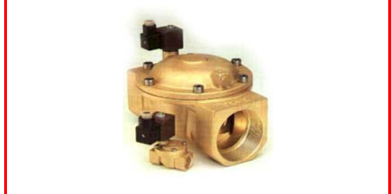
Válvulas a solenoide Cuerpo: Bronce Extremos: Roscados Diámetros: 1/2", 3/4", 1", 1 1/2" y 2"
